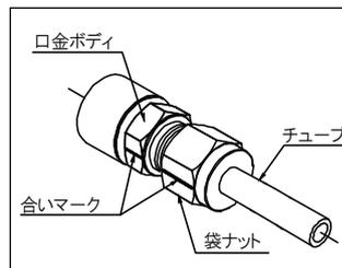
2. 袋ナットを指で回らなくなるまで締め付けた後、口金ボディと袋ナットに合いマークを付けてください。
